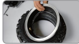
(6) après remplacement, s'il vous plaît terminer l'assemblage du pneu dans l'ordre inverse
