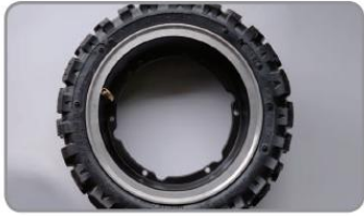
(3) Séparer la roue et le moteur avec un outil
