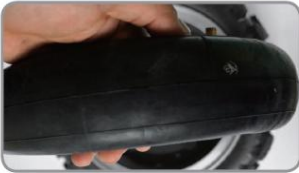
(5) Remplacer le tube avec un nouveau tube si la partie de la perforation du tube est trop grande pour réparer
